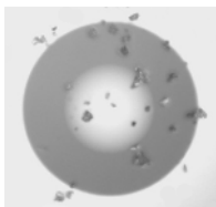
Verschmutzung der empfindlichen Faseroberfläche durch Staub
